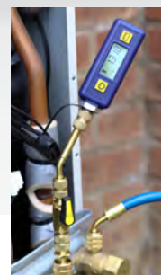
5° gebogene 1/4-Börsenbuchse zum direkten Anschluss an das System für eine genauere Ablesung
